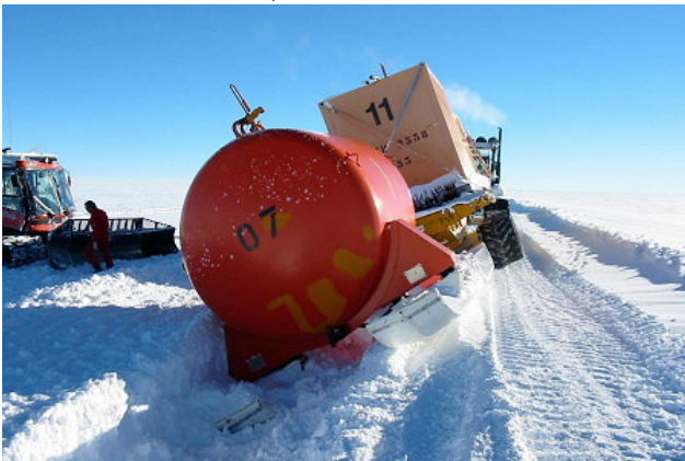
Divers incidents sont susceptibles de se produire pendant le parcours : pannes mécaniques qui peuvent conduire à laisser sur place un véhicule qui sera remorqué au retour, ou « enlèvement » dans de la neige plus fraîche sur le côté de la piste comme ici. (doc. IPEV/ Patrice Godon)
