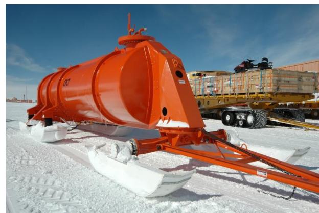
Une des citernes du « raid ». 40 à 50 % de la masse transportée est constituée de carburant. (doc. IPEV / Denis Petermann)
