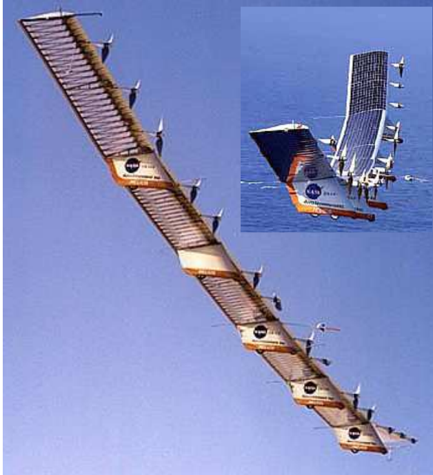
Hélios : 74,3 m d'envergure et 14 moteurs électriques alimentés par panneaux solaires sur l'aile. Dans l'encadré en haut à droite, l'impressionnante flexion de l'aile. (doc. NASA)
